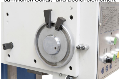
Gewindeschneideinrichtung mit Drehrichtungsumkehr, ideal für die
