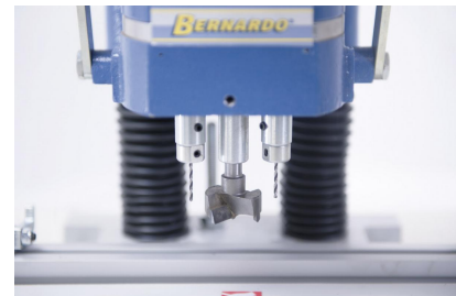
3-Spindelbohrkopf mit Beschlagbohrer diam. 35 mm links und 2 Stk. Bohrer diam. 2 mm rechts
