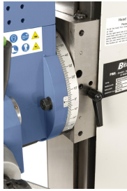
Wartungsfreie Schwalbenschwanzführung mit nachstellbarer Keilleiste.
