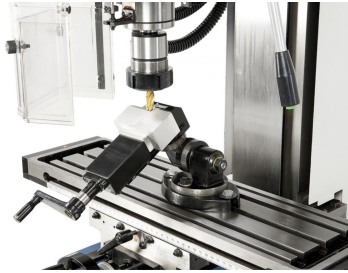
Fräsen mit Dreiachs-Gelenkschraubstock PGS 50.
