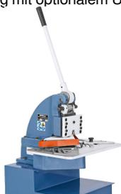
Mechanische Kraftübertragung mittels Exzenter.
