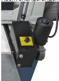
Variabel einstellbare Vorschubgeschwindigkeit.
