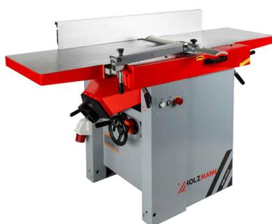
Die HOLZMANN HOB410ECO\_230V Abricht-Dickenhobelmaschinen mit 410mm Hobelmesslerlänge, Abricht-Dickenhobelfunktion und optional mit Verlängerungstisch sollte in ihrer Holzwerkstatt nicht fehlen. Sehr einfaches Umrüsten von Abricht auf Dickenhobel bzw. Dickenhobel auf Abricht.
