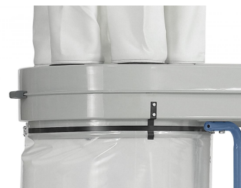
Einfacher Wechsel der Spänesäcke durch spezielle Klemmhaltung
