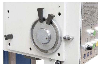
Gewindeschneideinrichtung mit Drehrichtungsumkehr, ideal für die Serienfertigung
