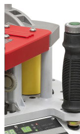
Komfortable Vorschubregelung von 2 – 6 m/min am Handgriff, ideal zum Bearbeiten unterschiedlichster Werkstücke
