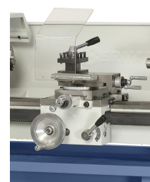
Leichtgängiger und präziser Schlitten mit Obersupport, lange Lebensdauer durch spielfrei nachstellbare Keilleisten
