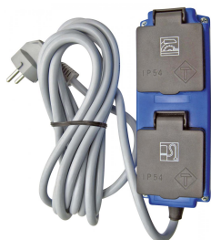
Einschaltautomatik ALV 2 / M 230 - 230V: Beim Ein- bzw. Ausschalten der Holzbearbeitungsmaschine wird die Absauganlage mit Zeitverzögerung zu- bzw. abgeschaltet (Option)
