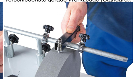
05-2058 Diamant-Abziehvorr. Zum kreisrunden und plangenaue Abrichten der Schleifscheibe
