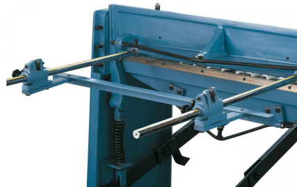
Robuster Hinteranschlag, einstellbar von 0 - 700 mm.
